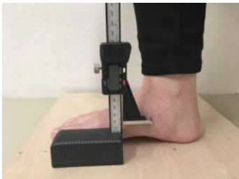
図3 ノギスを使用したアーチの測定方法
